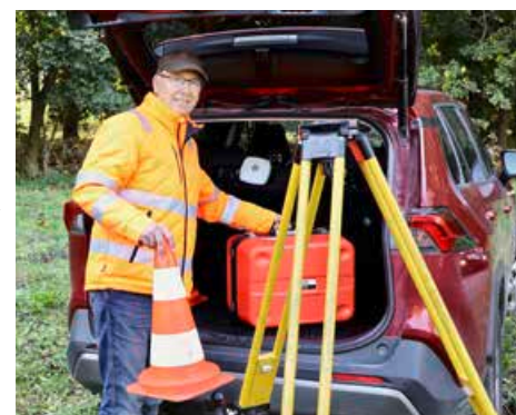
Mit der Robotikstation und dem Computertachymeter erfasst, berechnet und speichert Vermessungstechniker Maik Heese Richtungen, Winkel und Distanzen.
