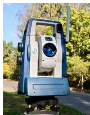
Mit der Robotikstation und dem Computertachymeter erfasst, berechnet und speichert Vermessungstechniker Maik Heese Richtungen, Winkel und Distanzen.
