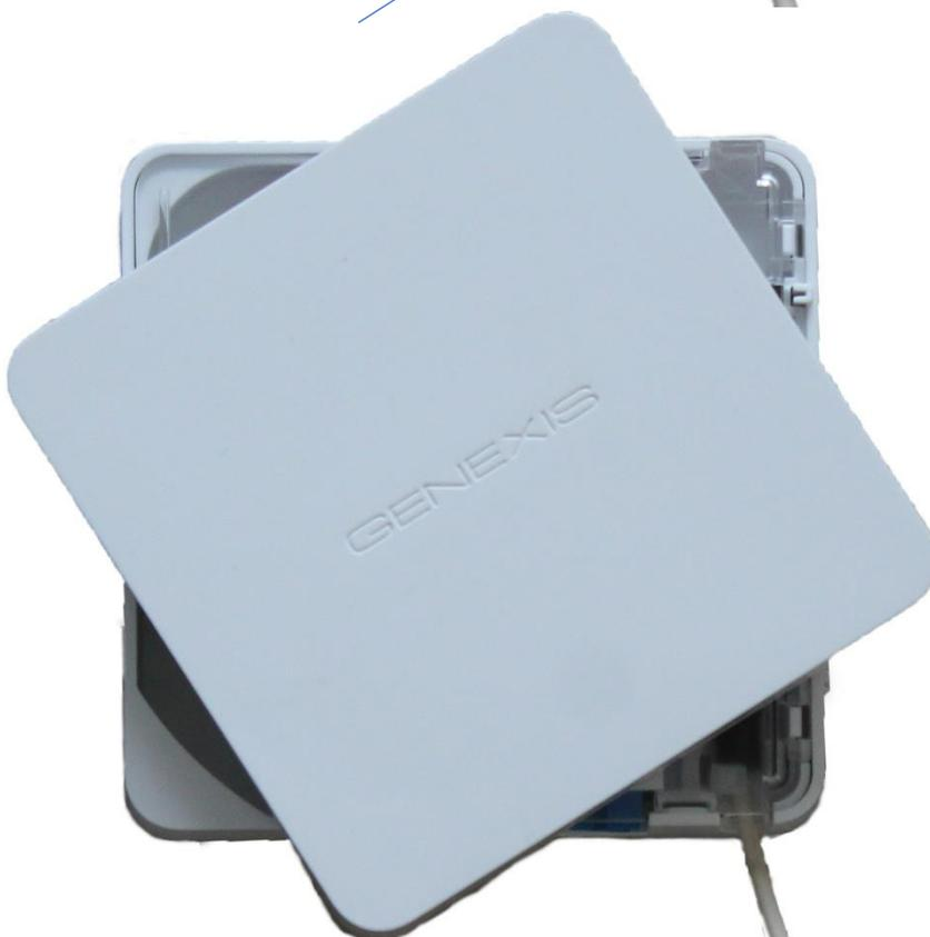
Nachdem die Schutzhülle wie beschrieben angebracht wurde, muss der Deckel auf die Box gesteckt werden. Halten Sie den Deckel leicht schräg, so dass der GENEXIS-Schriftzug von links unten nach rechts oben zeigt. Drehen Sie den Deckel wieder nach rechts, bis er einrastet.
